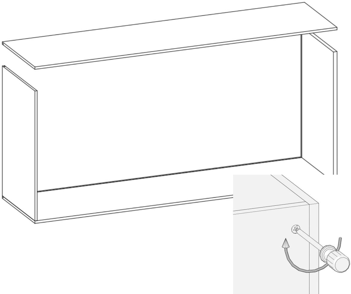
Stecken Sie nun die Böden auf die Schrankseite. Ziehen Sie die Excenter im Unter- und Oberboden fest an. Legen Sie nun die andere Seite auf die Böden und ziehen die Excenter ebenfalls an.
