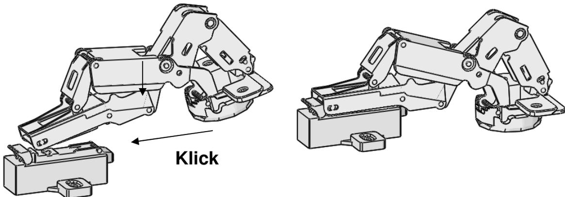
Halten Sie die Tür auf Höhe der angeschraubten Montageplatten. Diese verfügen über eine Schnellmontagetechnik (werkzeuglose Montage). Die Türscharniere werden aufgeschoben, bis diese hörbar einrasten.
