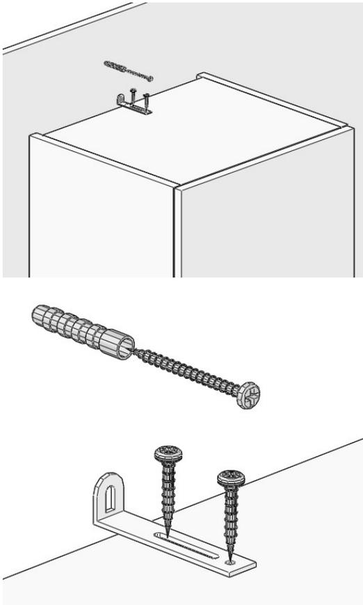
Der mitgelieferte Dübel ist nur für Massivwände geeignet. Für die Befestigung an anderen Wänden (z.B. Gipskarton) müssen Spezialdübel verwendet werden. Schraube + Dübel im Mauerwerk
