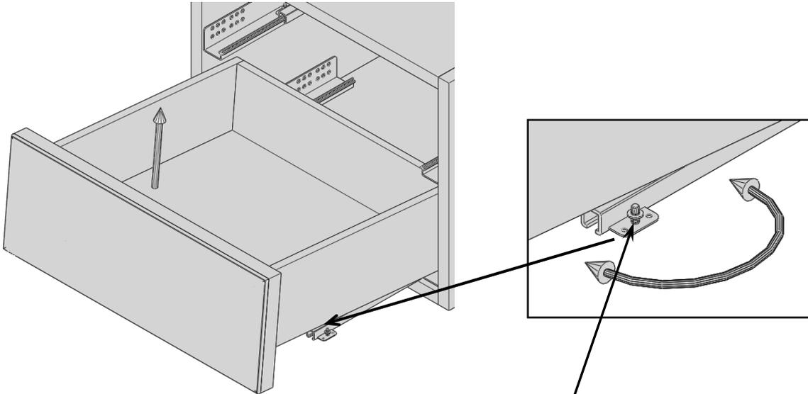
Heben Sie den Schubkasten im vorderen Bereich leicht aus. Verstellen Sie die Höhe durch das Drehen der Auflagescheibe am Sicherungsbolzen. Setzen Sie den Schubkasten nach dem Justieren wieder auf den Sicherungsbolzen.
