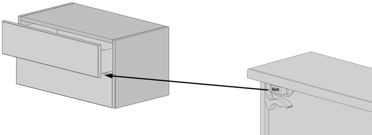
Öffnen Sie den Schubkasten. Verdrehen Sie das Stellrad an der Kupplung in die gewünschte Richtung, um den Schubkasten zu heben oder zu senken. Der Schubkasten muß nicht ausgebaut werden.
