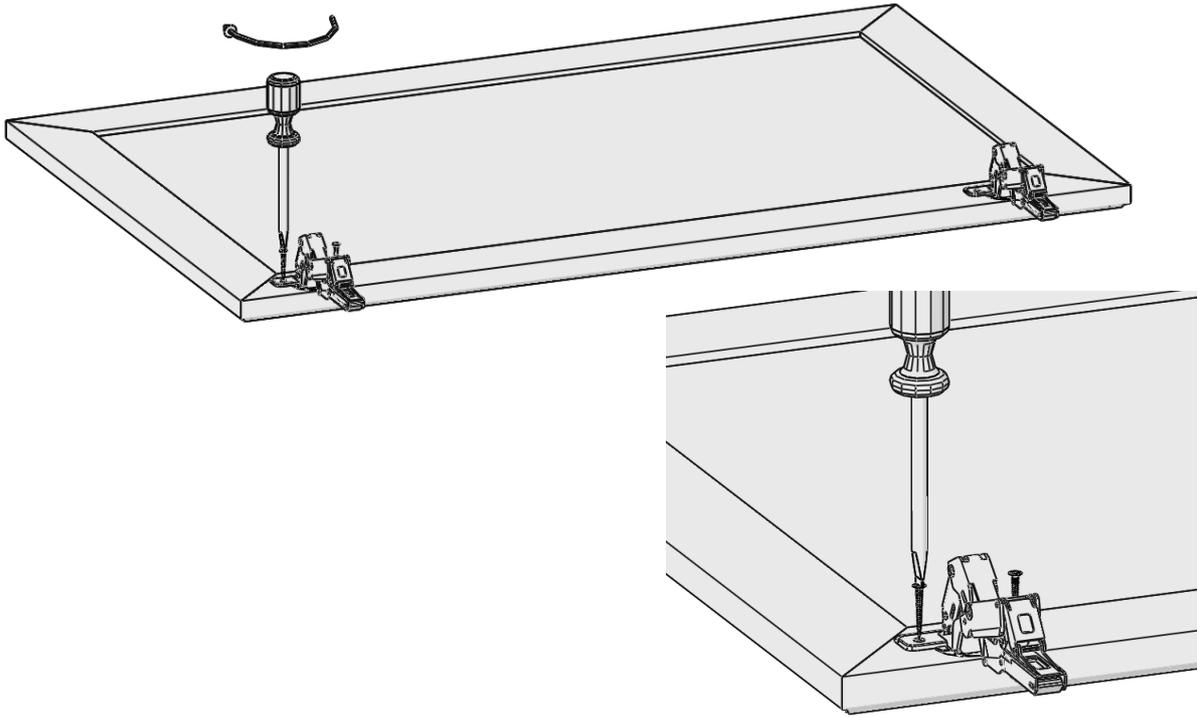
Nehmen Sie die Scharniere und Montageplatten aus dem Beschlagkarton. Stecken Sie die Scharniere in die vorgebohrten Löcher in der Tür mit den 3,5x15 Schrauben.
