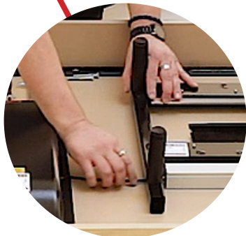
Kabel durch Kabelführung legen
