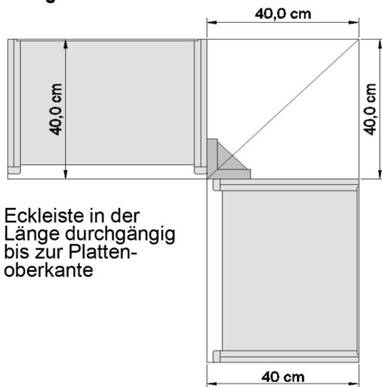
Eckleiste in der Länge durchgängig bis zur Plattenoberkante
