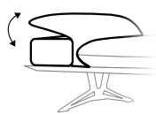
ARMLEHNE C ARMREST C Aufgelegtes Kissen mit Raster-Funktion Overlaid cushion with rat- chet function
