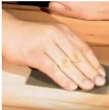
in Faserrichtung ausschleifen
