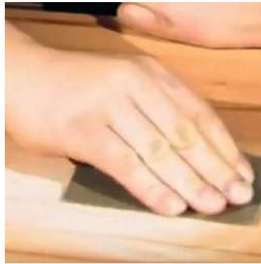
in Faserrichtung ausschleifen
