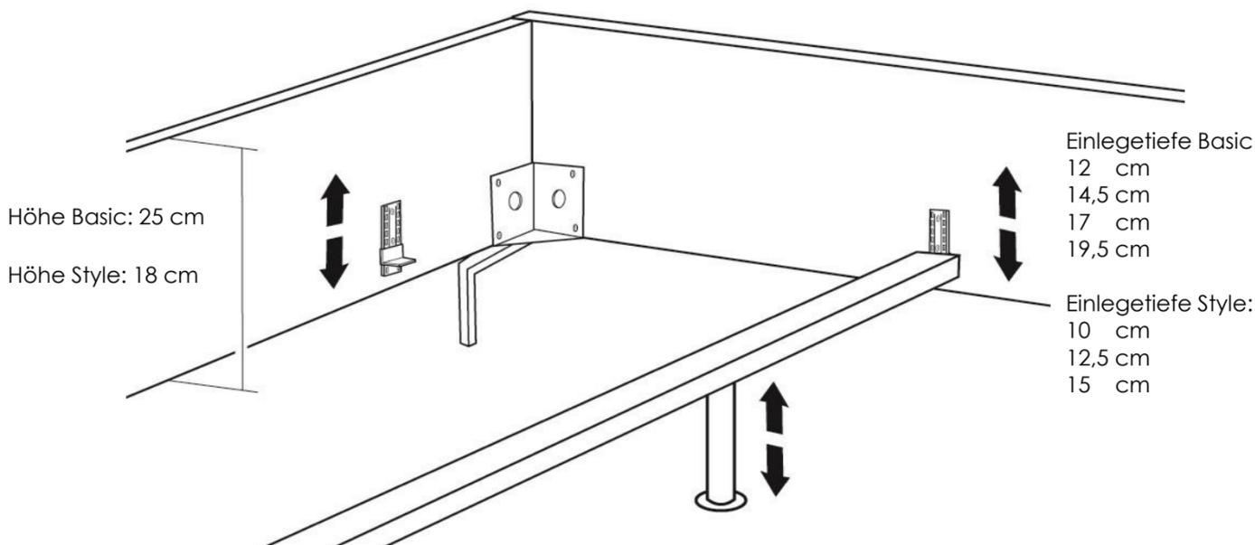
Zum sicheren Fixieren der Lattenroste werden serienmäßig vier Distanzhülsen und Schrauben mitgeliefert.
