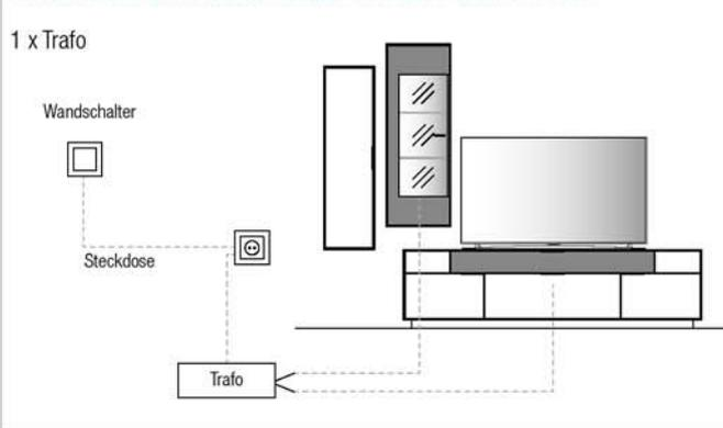
Bitte am Ende Ihrer Planung die Gesamtwattzahl ermitteln und den/die entsprechende(n) LED-Trafo(s) sowie die gewünschte Schaltervariante(n) definieren. Optional kann der Schalter durch einen Funkdimmer ersetzt werden, sodass Sie die Beleuchtung per Fernbedienung bequem vom Sofa aus steuern können. Diesbezüglich sollte dem Auftrag unbedingt eine Planungsskizze hinzugefügt werden.
