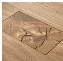
Hirnholzeinlage mit offenen Rissen
