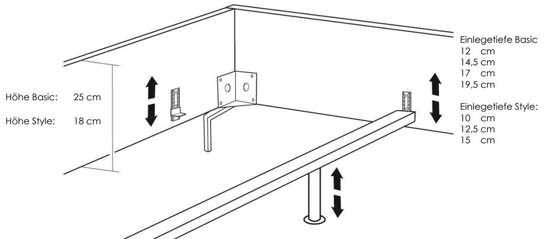
Zum sicheren Fixieren der Lattenroste werden serienmäßig vier Distanzhülsen und Schrauben mitgeliefert.
