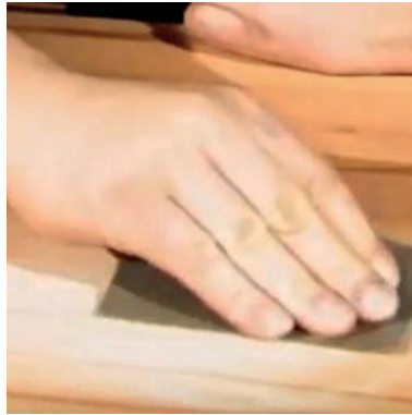
in Faserrichtung ausschleifen
