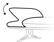
ARMLEHNE B ARMREST B Butterfly Kissen mit Raster-Funktion Butterfly cushion with rat- chet function
