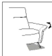
Liegearmlehne in allen Elementen mit Armlehne möglich. LAL in der Grundposition B 19 cm und als Basis für die Typenplanmaße. In der Funktion verändert sich die Breite auf B 26 cm.
